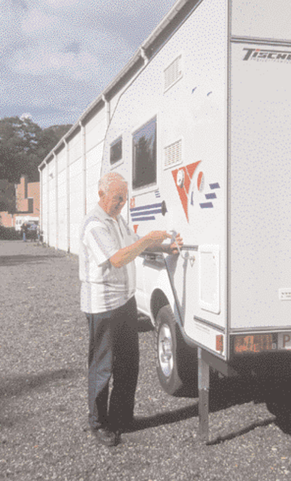
Bij middel van een hendel worden de steunen omlaag gedraaid als de wooncel van de wagen moet.
